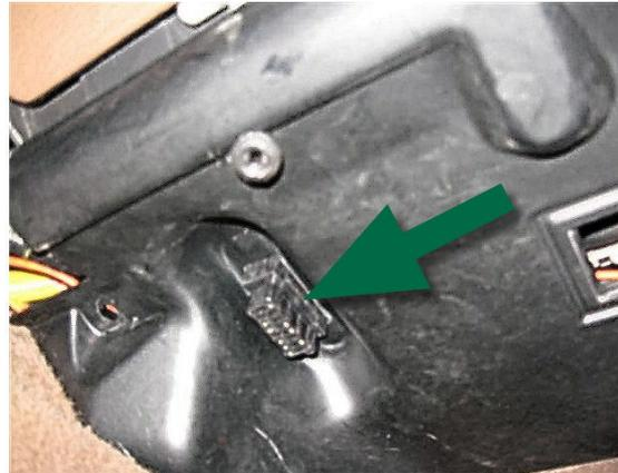
2- Luego, con la llave de contacto en la posición II (o el motor en marcha, es indiferente) se procede a conectar el dispositivo en este conector, que sólo es posible en una única posición
