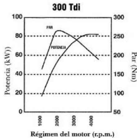
Potencia máxima a 4000 r.p.m. 83 kW (111,3 HP)
